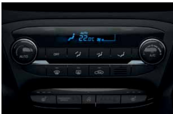
Automatyczna klimatyzacja. Wystarczy wybrać odpowiednią temperaturę, a system zadba o całą resztę. System klimatyzacji wyposażony jest w funkcję automatycznego odparowywania szyb, która dba o ich przejrzystość.
