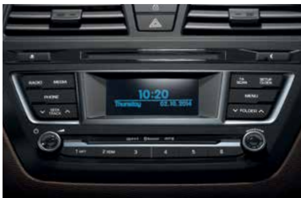
System audio. Radio RDS z odtwarzaczem CD/MP3 i łącznością Bluetooth dysponuje pamięcią o pojemności 1GB. Kierowca ma również możliwość sterowania systemem za pomocą przycisków na kierownicy. Bluetooth jest zarejestrowanym znakiem towarowym Bluetooth SIG Inc
