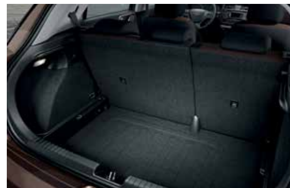
Podłoga bagażnika o regulowanej wysokości. Podłogę bagażnika można zamontować na dwóch różnych wysokościach, aby uzyskać płaską powierzchnię ładunkową przy złożonych tylnych siedzeniach lub bardziej pojemny i głębszy bagażnik.
