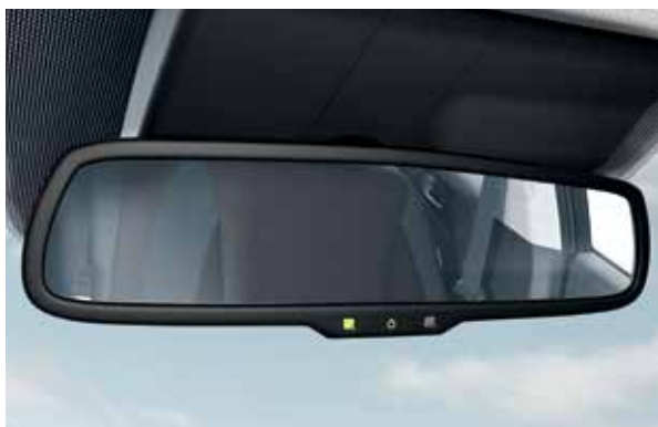
Elektrochromatyczne lusterko wsteczne (ECM). Lusterko wsteczne przyciemnia się automatycznie w momencie, gdy czujnik wykryje strumień oślepiającego światła z reflektorów samochodu jadącego z tyłu.
