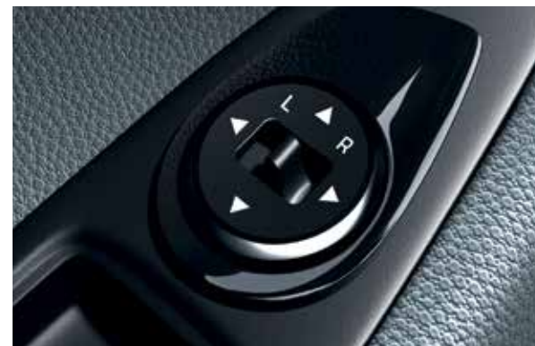
Elektrycznie sterowane i podgrzewane lusterka. Położenie lusterek zewnętrznych można regulować zdalnie za pomocą przycisków umieszczonych na konsoli w drzwiach. Dostępna jest również funkcja ich ogrzewania.
