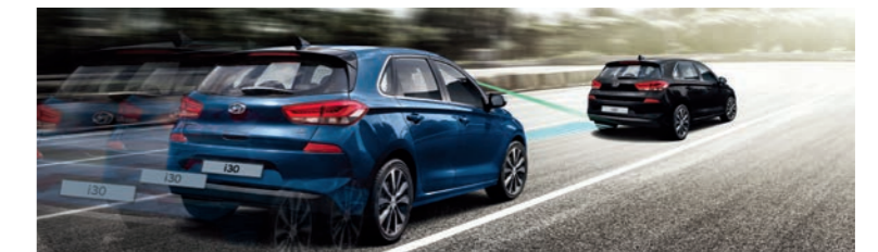
System autonomicznego hamowania (AEB). W przypadku wykrycia potencjalnego zderzenia z pojazdem lub pieszym, system w pierwszej kolejności uruchamia wizualne i dźwiękowe ostrzeżenia, a następnie automatycznie hamuje.
