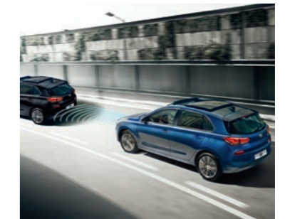
Aktywny tempomat (ASCC). Utrzymuje ustawiony przez kierowcę dystans do jadącego z przodu pojazdu, automatycznie regulując prędkość (dostępny tylko ze skrzynią 7DCT).
