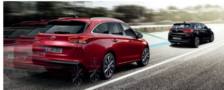
System autonomicznego hamowania (AEB). W przypadku wykrycia potencjalnego zderzenia z pojazdem lub pieszym, system w pierwszej kolejności uruchamia wizualne i dźwiękowe ostrzeżenia, a następnie automatycznie hamuje.
