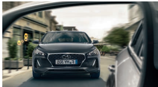
System monitorowania „martwego pola” (BSD). Alarmy informują o wykryciu innych pojazdów w tzw. „martwym polu”.
