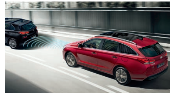
Inteligentny tempomat (ASCC). Utrzymuje ustawiony przez kierowcę dystans do jadącego z przodu pojazdu, automatycznie regulując prędkość.
